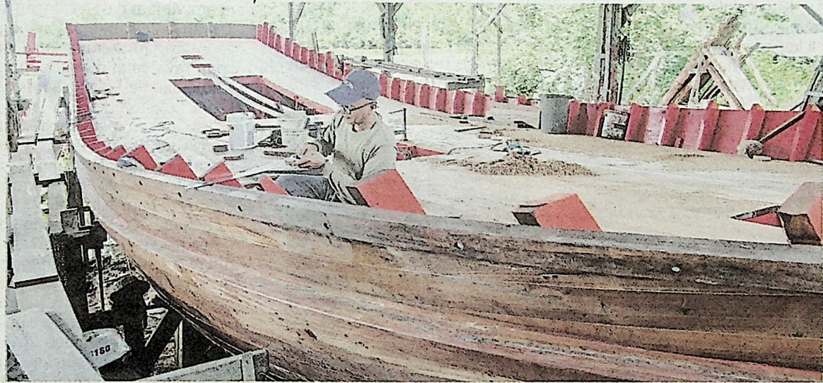
YUSOF Nabi tekun melakukan kerja-kerja membina bot nelayan secara tradisional yang ditempah pelanggan di Kampung Seberang Bukit Tumboh, Kuala Terengganu, semalam. - UTUSAN/ PUQTRA HAIRRY ROSLI
